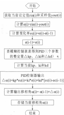
图 5 模糊 PID 算法流程
